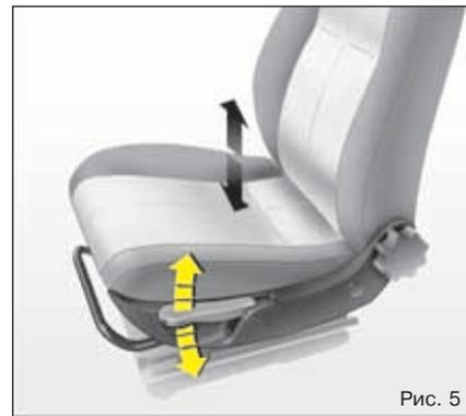
**Регулировка водительского сиденья по высоте:** качательными движениями рычага переместите сиденье на требуемую высоту. Для перемещения сиденья вверх рычаг следует перемещать вверх и наоборот
