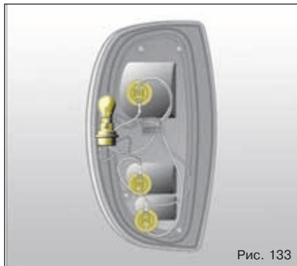
Замену ламп в **заднем фонаре** проводите со стороны багажного отделения, предварительно открыв клапан в обивке боковины багажного отделения. Для доступа к перегоревшей лампе поверните патрон против часовой стрелки и выньте его в сборе с лампой. Чтобы вынуть лампу из патрона нажмите на лампу и поверните ее против часовой стрелки.
