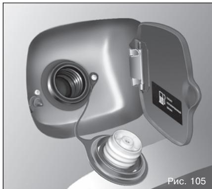
Заправочная горловина расположена с правой стороны автомобиля сзади. Откройте пробку топливного бака, поворотом против часовой стрелки, снимите ее и повесьте на заправочный лючок.
