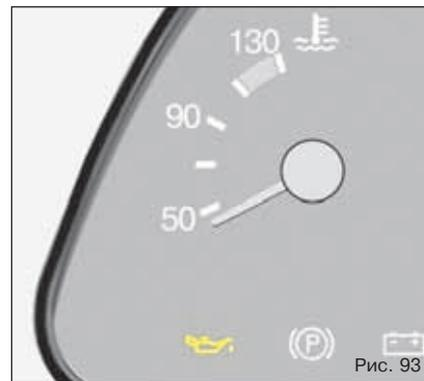
Не допускайте эксплуатации автомобиля с горящей контрольной лампой недостаточного давления масла
