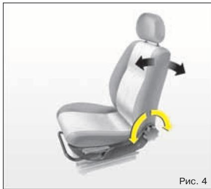
**Регулировка угла наклона спинки передних сидений:** вращением рукоятки переместите спинку сиденья в требуемое положение. При регулировке не нагружайте спинку сиденья.
